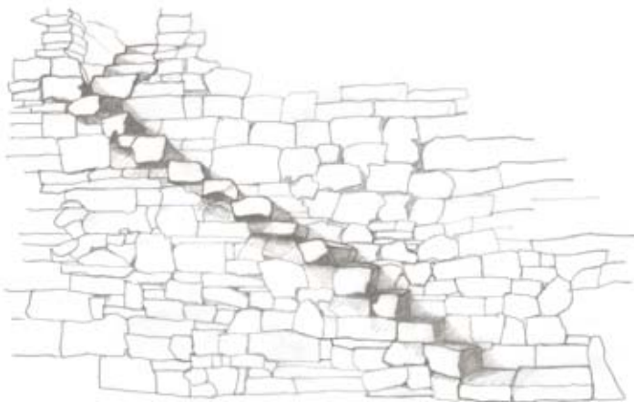
2 Bij treden langs stapelmuren wordt vaak met blokken gewerkt.
