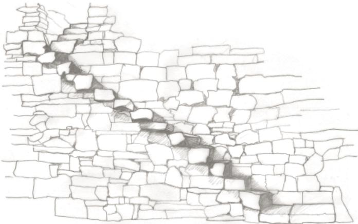
2 Treppenstufen an Trockenmauern bestehen häufig aus Steinblöcken.
